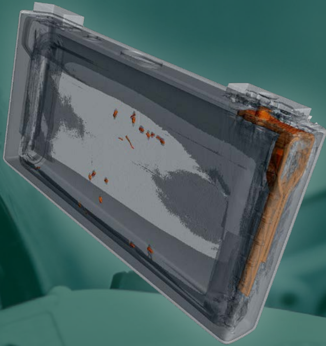
角形電池セルのCT検査による内包物の検出
