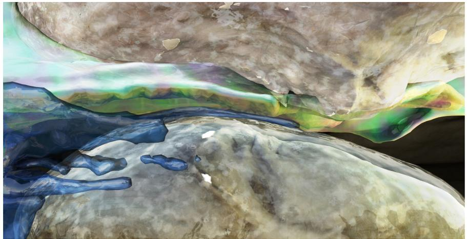
En presencia de agua, el polímero se expande, llenando los poros y aumentando así la resistencia al flujo de agua ( $R_w$ ).
