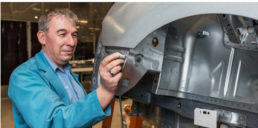
Krautkrämer SpotVision est une sonde pratique et facile à manipuler.
