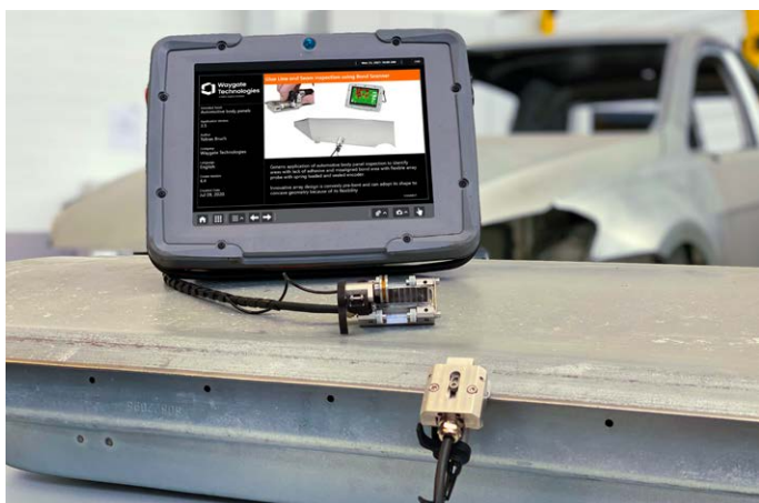
Le Bond Scanner de Krautkrämer permet le contrôle le plus rapide et le plus facile des pièces collées.
