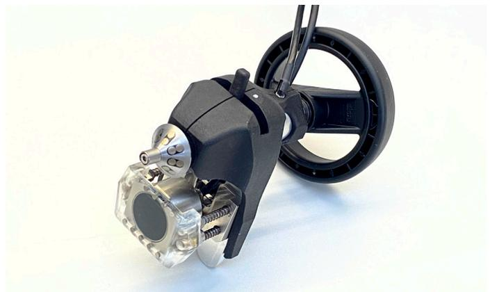
erforderlichen Einschallwinkel um kritische Bereiche der Achse optimal abzudecken. So ist eine zuverlässigere Prüfung möglich. Zusätzlich wird das Risiko des Ankoppelverlustes mit nur einem Phased Array-Prüfkopf reduziert und so die Gefahr, dass ungeprüfte Bereiche entstehen minimiert.
